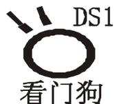
2316 Plus系统由“看门狗”高级电路来保护，此电路监控微处理器的工作。控制主机正常工作情况下看门狗LED (DS1) 会持续闪烁。如电路检测到错误，它将重置控制主机。
